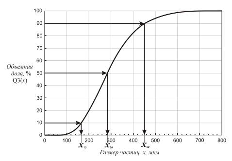
x — размер частиц, определяемый как диаметр объема эквивалентной сферы; Q3(x) — объемная доля частиц с размером x и менее;  $x_{10}$ ,  $x_{50}$ ,  $x_{90}$  — размер частиц, соответствующий объемной доле 10, 50 и 90 % соответственно Рисунок 2 — Интегральное объемное распределение частиц по размеру
