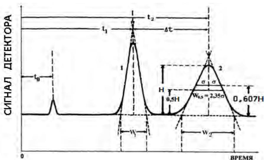
Рисунок 2 – Хроматограмма и основные хроматографические параметры: 1 и 2 – пики соединений 1 и 2;  $t_1$  и  $t_2$  – соответствующие времена удерживания;  $t_0$  – время удерживания несорбирующегося вещества;  $W_1$  и  $W_2$  – ширина пиков у основания;  $W_{0,5}$  – ширина пика на половине его высоты (предполагается гауссова форма пиков)
