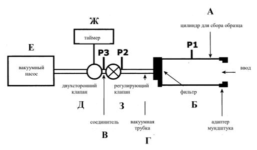
Рис. 2 — Прибор для определения однородности дозирования в порошковых ингаляторах
