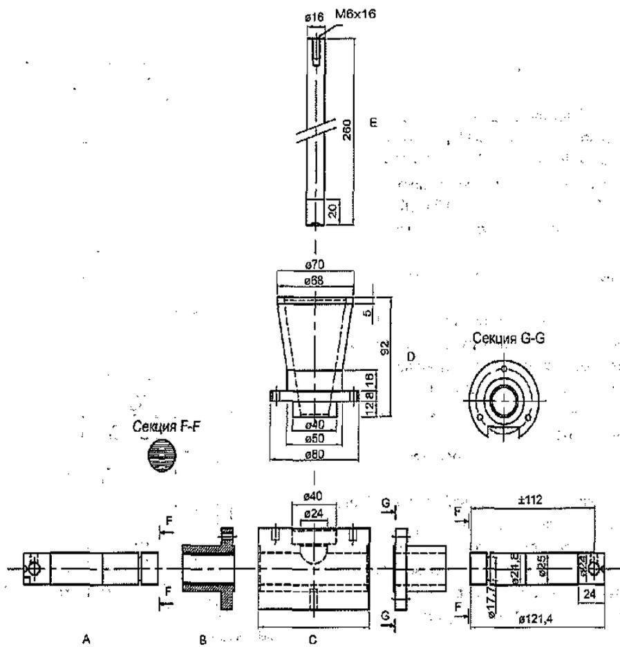
Рисунок 1 – Прибор А для имитации жевания.
